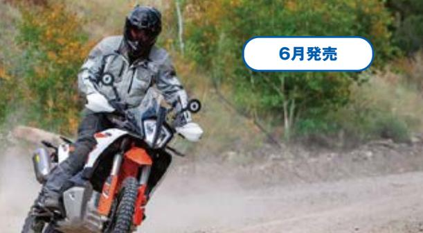
意匠性とタフさを兼ね備える可倒式ミラーの「ダブルテイクミラー」が新しくなりました。高強度ナイロン樹脂(Zytel®)により成型されたミラー本体、アルミダイカスト製の頑丈なアーム、フレキシブルでしっかりとした固定を実現するボールジョイントの組み合わせにより、他にはない利便性と頑丈性を持つミラーです。
