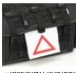
非常停止時にフラップから反射材を使用した三角表示を取り出す事で視認性を上げる事ができます。
