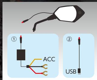
給電方法は2パターン、①車体電源ACC連動、もしくは、②既に取付けられている5VのUSB電源でも起動可能。
