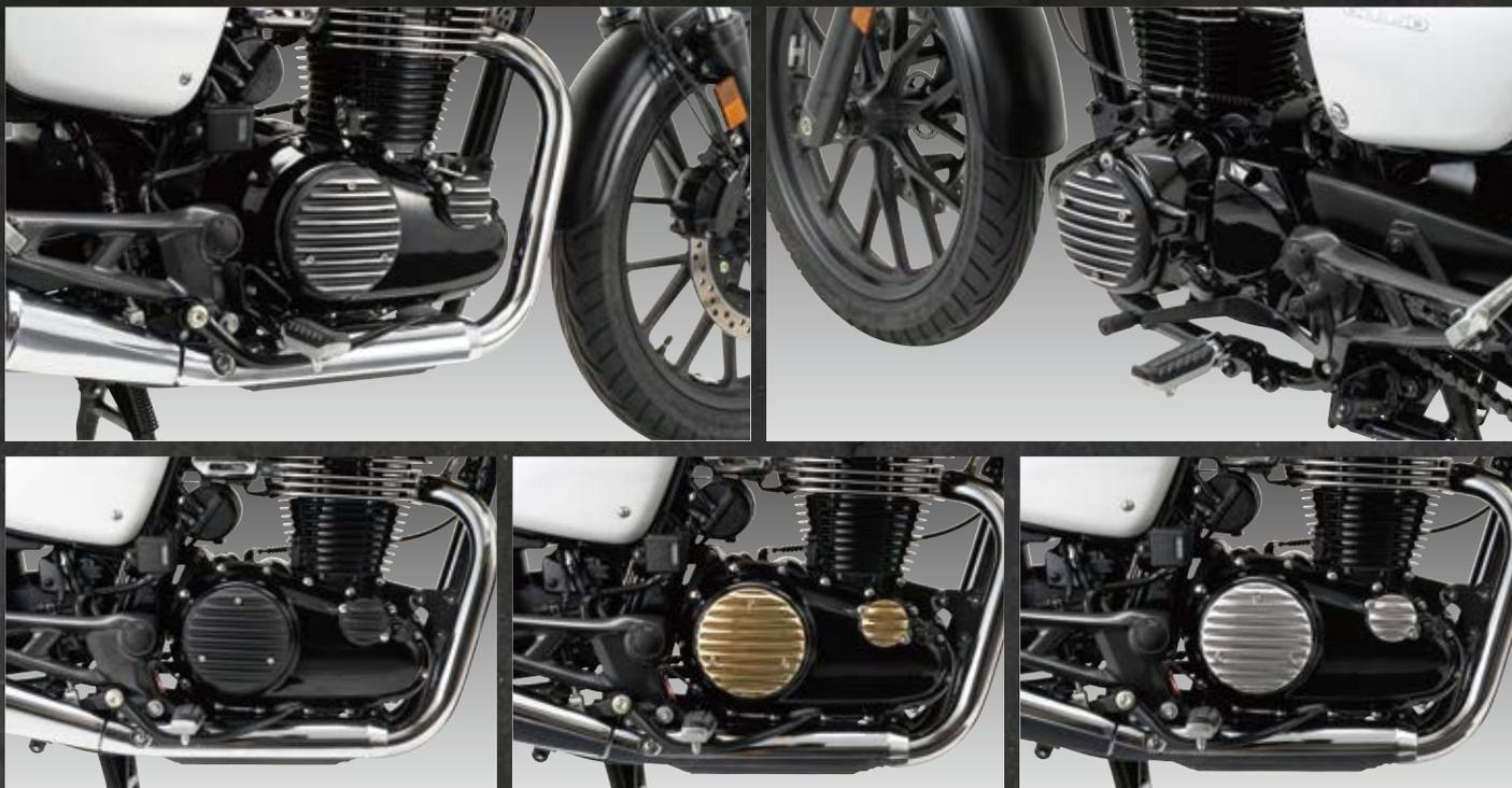
空冷フィンを彷彿とさせる「リブデザイン」を採用したエンジンカバーとオイルフィルターカバー。
