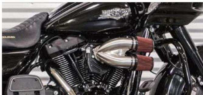
S&Sの高性能エアクリーナーキット“チューンドインダクション”がM8~TCの多くの車両に適合となりました。ボルトオンで吸気効率を最大化したいライダーには、特におすすめ(インジェクションチューニングを併せておすすめいたします)。管長を確保した2in1スタイルで、中~高回転域の吸気量を増加させることができ、確実なパワーアップにつながります。レーシーなアピラランス。カスタム効果の高いパーツです。
