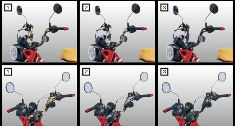
■車種専用設計 / ノーマルのブレーキホース、スロットルケーブル、配線類をそのまま使えます。スイッチボックスの回り止めが収まる穴を加工済み。純正ウインカーをハンドルに固定する為のワッシャーセットも付属。 ■ポジション / 純正比(7mmUP/7mmBACK) ■ハンドル外径φ22.2 / アルミ ■ハンドル内径 / φ14.0 ■クランプ部ローレット加工 ■ポリッシュド・アルマイト仕上げ ■内径φ14.0に対応したバーエンドが別途必要。純正バーエンド使用不可。 ■ホンダ純正オプショングリップヒーター同時装着不可。
