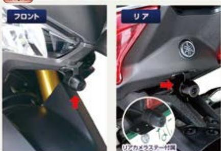
200万画素のカメラセンサーを搭載した2カメラ仕様。昼夜問わず鮮明な映像を撮影します。IP67相当の防水防塵に対応。対角158°の広視野角、明暗自動調整機能を搭載。全国のLED信号に対応しています。
