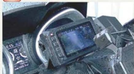
防水防塵規格 IP65の3インチ防水モニターを採用。専用ステーでハンドル周りへの取り付けが可能。走行中のスピード表示、時計表示、撮影中の画像表示(前方/後方/2分割)が可能です。
