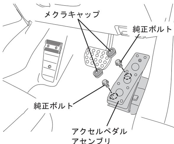
6. アクセルペダルアセンブリを取り外しと逆の手順で取り付けます。
