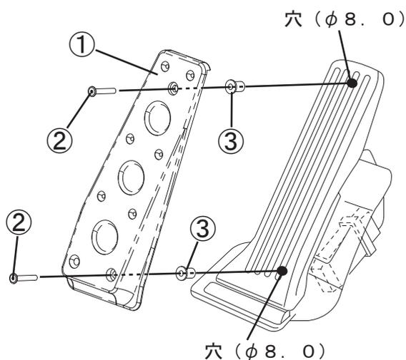
4. アクセルペダルアセンブリにアクセルペダルNEO①をあてがい、ボルト穴位置をマーキングした後、電動ドリルでφ8.0の穴を開けます。
