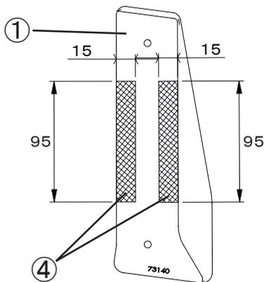
3. 付属の両面テープ④をカットし、図のようにアクセルペダルNEO①の裏面に貼り付けます。
