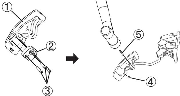
5. アクセルペダルNEO①にアタッチメント②を、キャップボルト③を使用して取り付け、アクセルレータロッドに差し込み、スプリングピン⑤、六角穴付止めネジ④で固定します。
