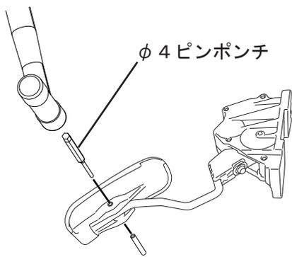
4. φ 4 のピンポンチを使用して純正アクセルペダルを固定しているスプリングピンを打ち抜き、アクセルレータペダルアセンブリから取り外します。
