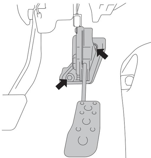
7. アクセルレータにカプラが接続されている事を確認し、車両バッテリーのマイナス端子を接続します。
