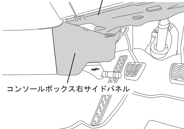
6. カットしたコンソールボックス右サイドパネルと、インストルメントパネルアンダーカバーを元に戻します。
