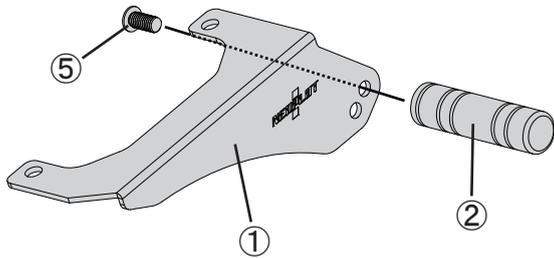
3. ブラケット①にフットバー②をボルト⑤を使用して固定します。
