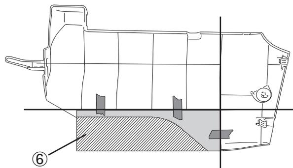
5. 「1.」で取り外したコンソールボックス右サイドパネルの裏面に付属の型紙⑥を貼り付け、プラスチックカッター等で、斜線部分をカットしてください。
