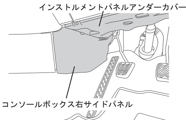
1. サーマニュアルに従って、インストルメントパネルアンダーカバーと、コンソールボックス右サイドパネルを取り外します。
