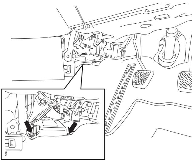
2. 矢印のエアバッグコントローラー取付ボルトを取り外します。
