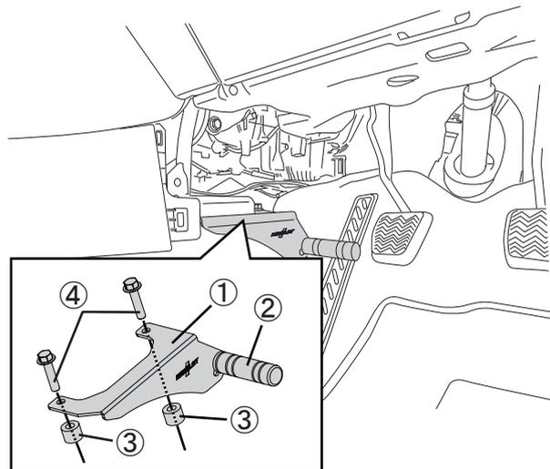
4. フットバー②を取り付けたブラケット①を、ボルト④、カラー③を使用して、「2.」で取り外したエアバッグコントローラー固定箇所に取り付けます。
