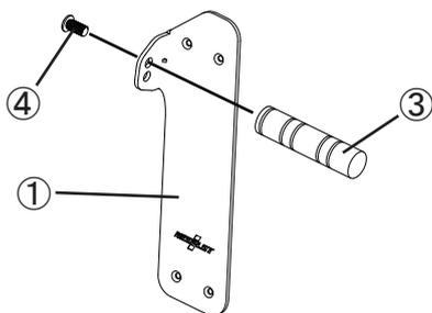
4. ボルト④を使用して、ブラケット①にフットバー③を取り付けます。
