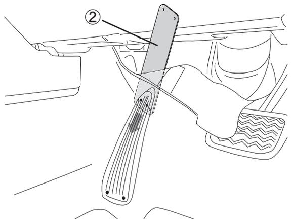
3. フロアカーペットをめくり、フットレストパッドとフロアカーペットの間にインナープレート②を入れ、フットレスト部に開けた穴とインナープレート②のネジ穴を合わせるようにして、フロアカーペットを戻します。
