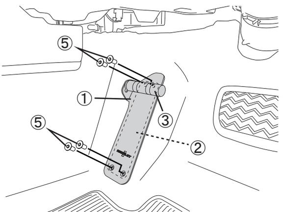
5. フットバー③を取り付けたブラケット①をボルト⑤を使用して、インナープレート②に固定します。
