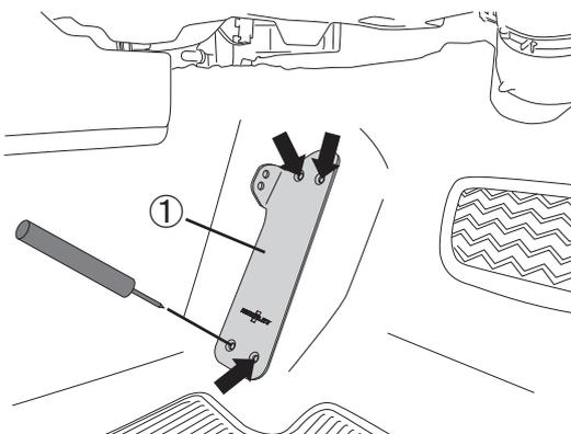
1. ブラケット①をフットレスト部に合わせて4箇所の穴部にマジック等でマーキングし、キリまたは千枚通しなどの穴あけ工具を使用して、穴を開けます。
