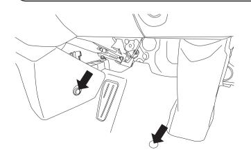
5 矢印部のクリップを取り外し、フロアカーペットをめくります。
