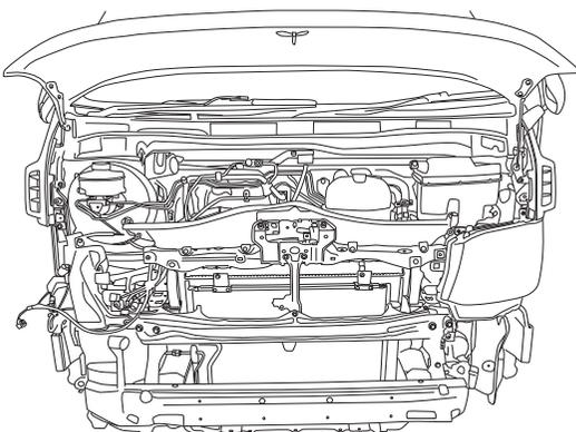
1. サーマニュアルに従い、左右ステッププレートカバー、フロントバンパーカバー、右ヘッドランプASSYを取り外します。
