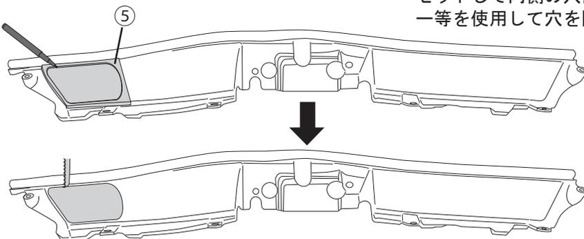
5. ラジエータグリルエアガイドの左図の位置に型紙⑤をセットして内側の穴部をマジックで印を付け、ジグソー等を使用して穴を開けます。
