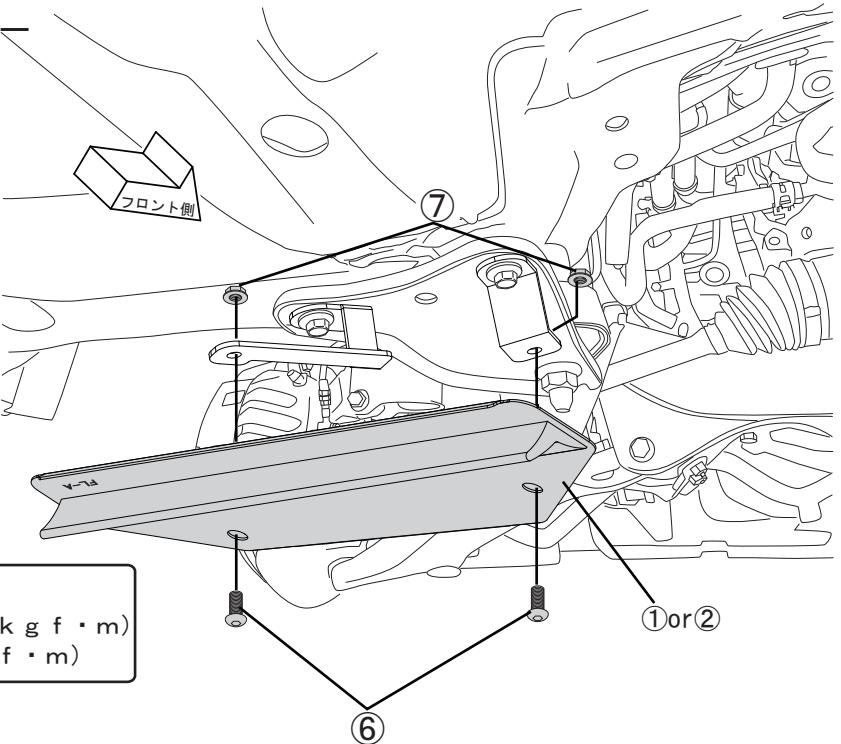
6. 純正ボルト、ボルト⑥を本締めします。
