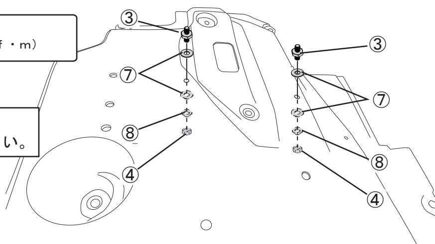
4. 取り外したアンダーフロアパネルを車体に取り付けます。
