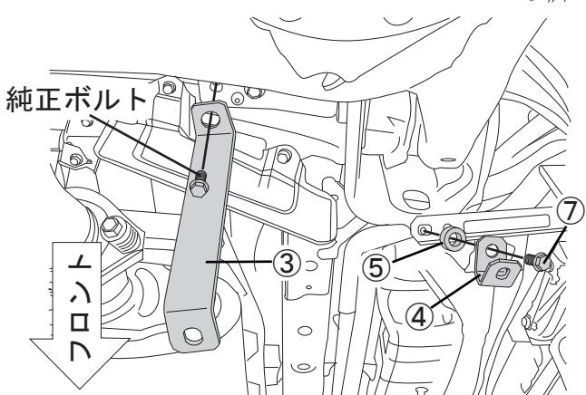
※純正ボルトは3で取り外した物を再使用してボディー側に取り付けてください。
