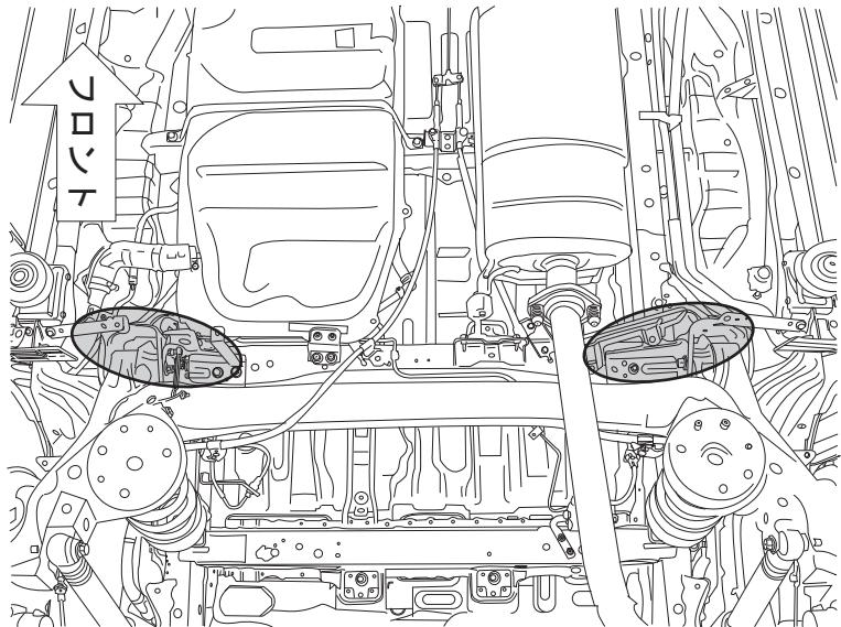
3. リヤタイヤ前方のボデーフレームに取り付けられている補強ブラケットのボルトとボディー矢印部分のボルトを取り外します。
