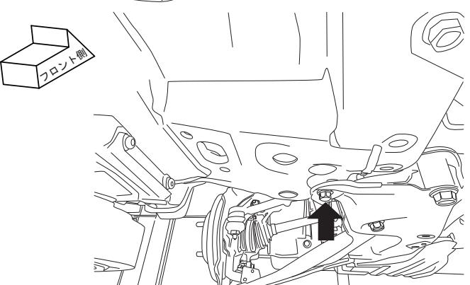
5. 純正ボルト、ITハンガーを使用してブラケットA、Bを車体に取り付けます。
