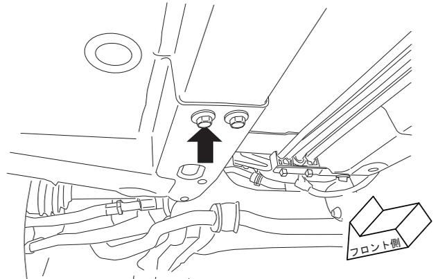
4. 純正ボルト、ITハンガーを使用してブラケットA Bを車体に取り付けます。
