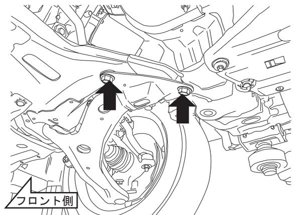
4. 純正ボルトを使用してブラケットA Bを車体に取り付けます。
