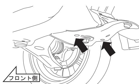
4. ボルト⑦ナット⑧を使用してブラケットを車体に取り付けます。
