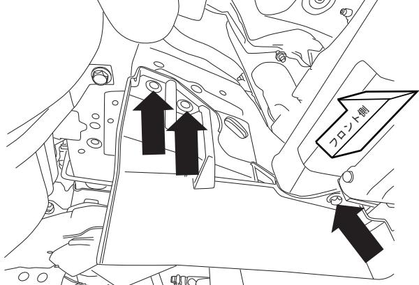
4. 車体裏側取り付け部分の純正ボルトを取り外します。
