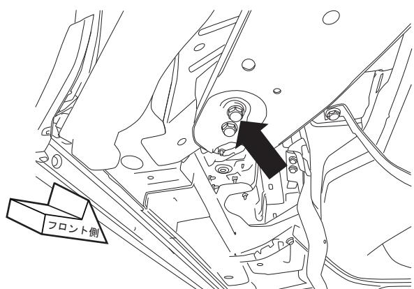
5. 純正ボルトを使用してブラケットA Bを車体に取り付けます。
