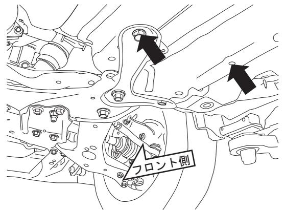
4. ボルト⑦、純正ボルトを使用してブラケットを車体に取り付けます。
