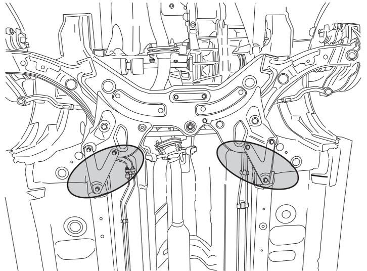
3. 車体裏側取り付け部分の純正ボルトを取り外します。
