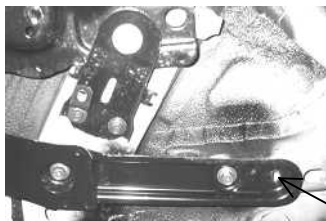
クロスメンバーが写真の形状の 場合 リヤスペーサー2を使用 して下さい。
