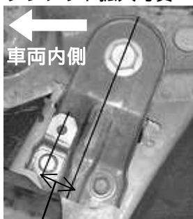
クロスメンバー補強ブラケットと フロント側ブラケットが平行 になる様にして下さい。
