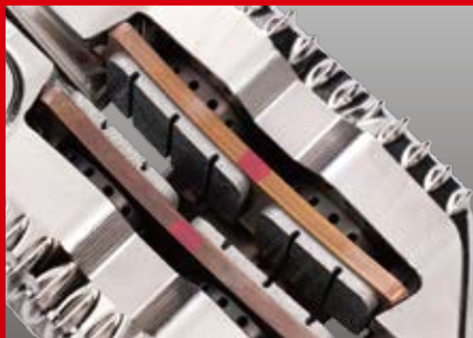
より大きな制動力を発揮する斜めのパッドアバットメント
