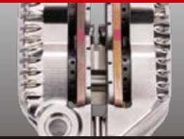
ブレーキフルードへの熱伝達を抑制するドリル加工レーシングピストン
