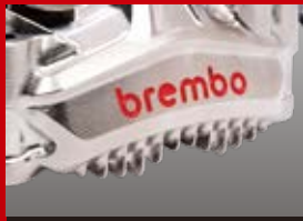
優れた冷却機能を備えたベンチレーションフィン付きボディ
