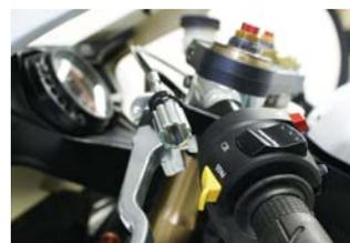
■仕様 ・ノブ/アルミ製 ・クランプ/ジュラコン製 ・クランプ幅/12mm ・ハンドルからノブまでのクリアランス35mm ・ワイヤー全長+25mmまで調整可能
