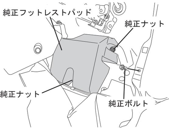
2. 発泡スチロール製の純正フットレストパッドを取り外します。
