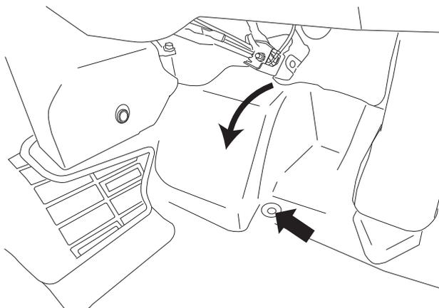
1. 矢印部のクリップを取り外し、フロアカーペットをめくります。
