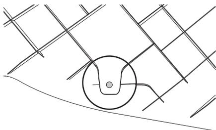
8. サイドカバーに付属カット型紙を貼り付け、プラスチックカッター等で、斜線部分をカットしてください。
