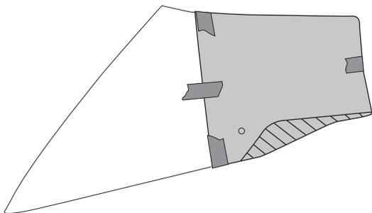
9. カットしたサイドカバーを元に戻し、ブラッシュクリップ④で固定します。
