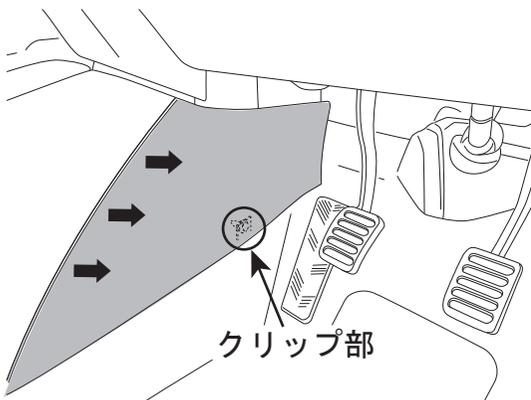
1. 右フロアコンソールサイドカバーのクリップ部を外し、サイドカバーを矢印の方向に取り外します。
