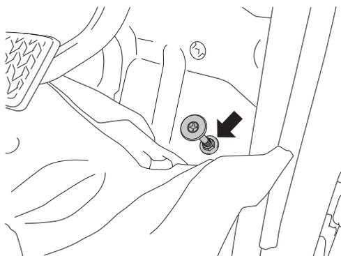
7. 矢印部のナットを緩め、純正ペダルストッパーを取り外します。
