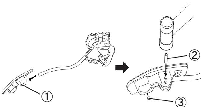
5. アクセルレータロッドにアクセルペダルNEO①を差込み、スプリングピン②、六角穴付止めねじ③で固定します。
