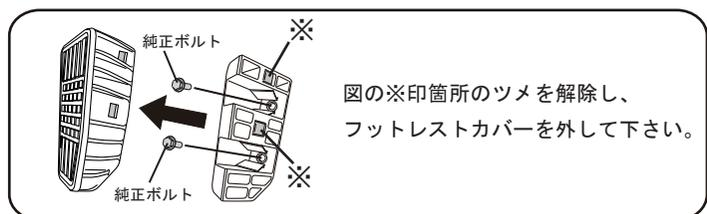
図の※印箇所ツメを解除し、フットレストカバーを外して下さい。
