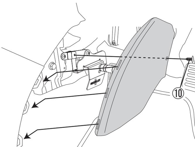
5. カットした純正カバーをツメ部にはめ込み補強ブラケットにブラッシュクリップ⑩を使用して固定します。
