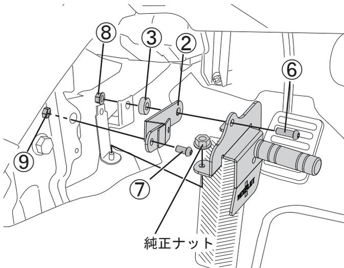
4. 組み付けたフットレストを車体に取り付けます。
