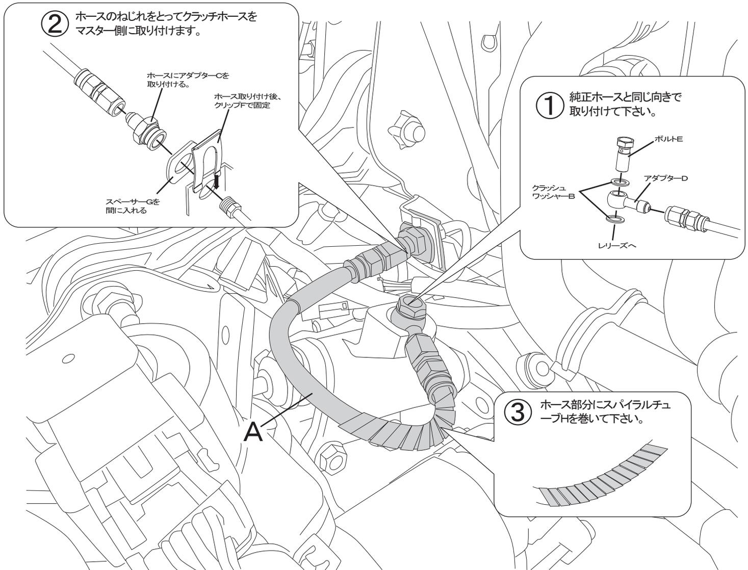
ホースを取り付け後、エア抜きを行い、各部にオイル漏れの無い事を確認して下さい。
