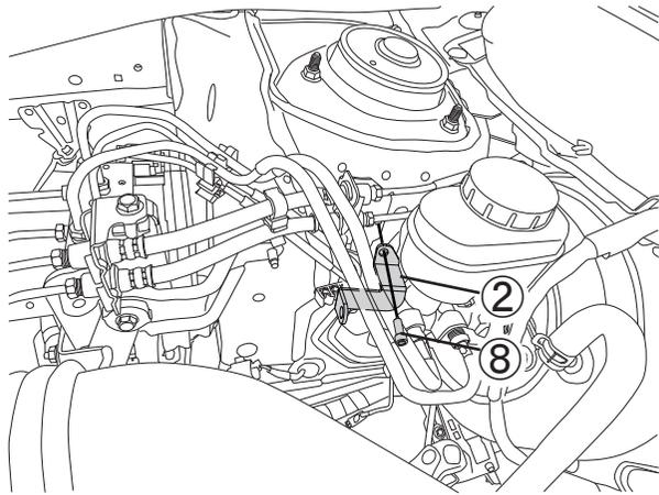
3. 左図のように取り外したボルト部分にマスターシリンダストップステー②をボルト⑧を使用して取り付けます。
