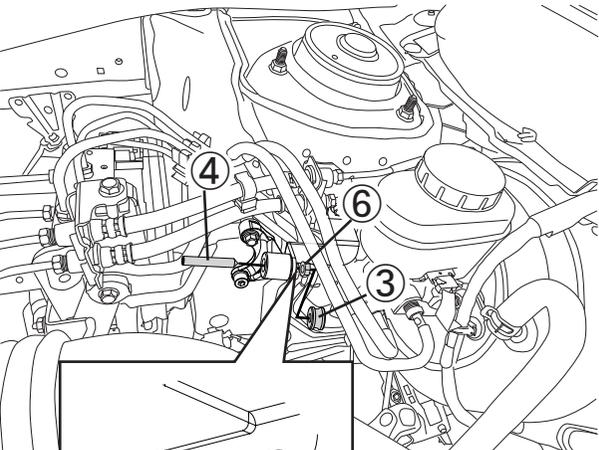
5. マスターシリンダストップパーに、トガリサキトメネジ④、ナット⑥、ナイロンカラー③の順に組み付けます。
