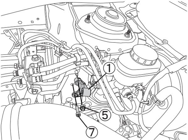
4. マスターシリンダストップパーを左図のように専用化粧ナット⑤ボルト⑦を使用して取り付けます。
