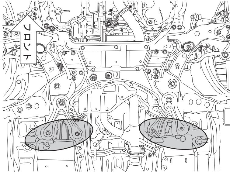
3. クロスメンバー補助ブラケットのボルトを取り外します。
