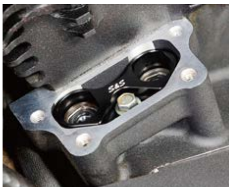
純正樹脂製タペットガイド(左)とS&Sタペットカフス(右)
