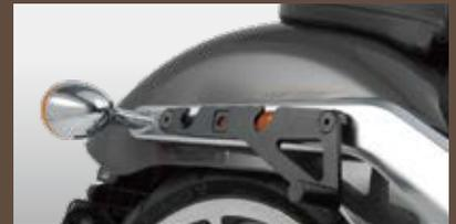
キャリアにバッグを引っ掛け、バッグ内部のピンを差し込み完全固定。外部からの取り外しができないため、バッグを施錠することで防犯性を高めます。
