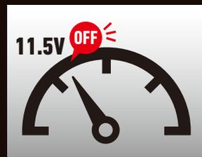
電圧抑制機能付きで低電圧時でも安心。11.5V以下になると自動で加熱を中止します。
