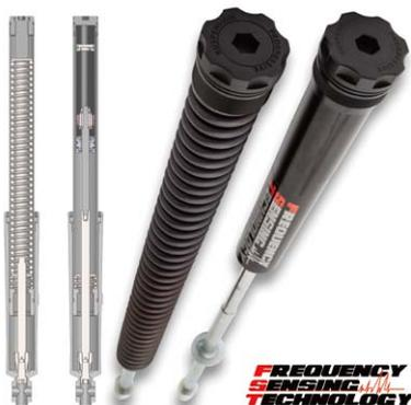
アシンメトリー(左右非対称)のフロントフォークキットは、FST(FREQUENCY SENSING TECHNOLOGY(振動感知技術))を新たに採用。左フロントフォークには、プログレッシブスプリング(不等ピッチスプリング)を採用することでコイル幅の狭いところで初期の負荷を緩和し、コイル幅の広いところで大きな負荷を吸収します。右側フロントフォークには、FST機構を搭載し高圧ガスが注入されたダンパーを入れる事により、加重や衝撃を感知した際に自動で調節し優れた反発力で衝撃を吸収します。2種類のフォークを組み合わせた結果、不快な路面からの振動、突き上げを緩和し、より快適なツーリングを実現する事が可能になりました。
