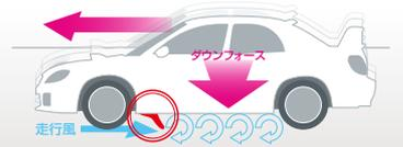
\* ダウンフォースとは、単純な質量以外の要因でタイヤを地面に強く押し付ける下向きの力のこと。
