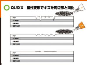
※図解は塗装面用2液タイプの塑性変形イメージです
