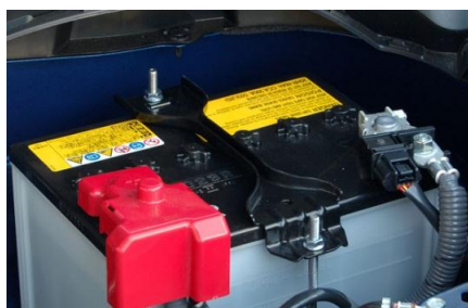
純正の状態。後ろ側のバッテリーロッドは、十分な長さがあるが、前側は短い。(Dサイズバッテリー搭載車)
