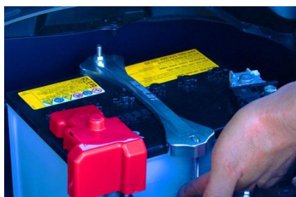
純正バッテリーロッドのままだと、前側のロッドが短いためナットを固定できません。(Dサイズバッテリー搭載車)
