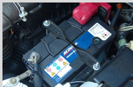
Bサイズバッテリーだが、Dサイズの位置で固定する純正クランプを採用している例 (車両例:トヨタポルテ / 型式:NNP1#)
